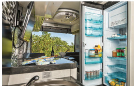
Réfrigérateur/congérateur 4.9 pi.cu. / 140 l. 110 volts, 12 volts et propane.
